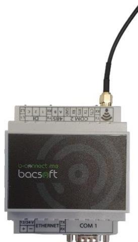
Figura 7: Antena conectada a la B-Connect Me 4G
