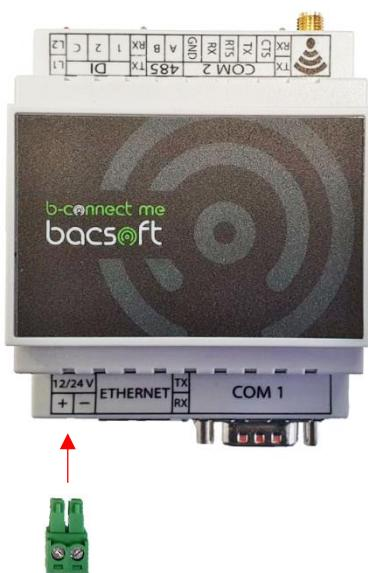
Figura 2: Bloque de terminales insertado
