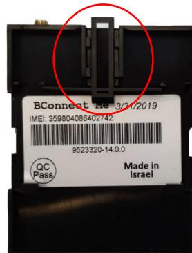
Figura 6: Gancho de montaje en pared.
