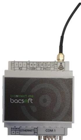
Figura 7: Antena conectada a la B-Connect Me
